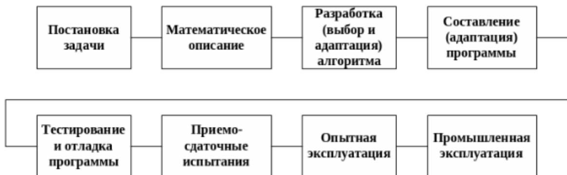
Рис.1 - Этапы разработки программного обеспечения.
